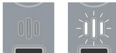
El LED de la base de acoplamiento no cambiará cuando el instrumento de mano TonoCare está guardado en la base de acoplamiento.
