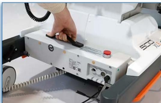
7. Insertar la caja de batería cargada (de repuesto) en el dispositivo colgante.
