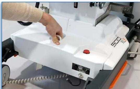
9. Montar la protección y volver a fijar el cable adaptador en el clip sujetacables.
