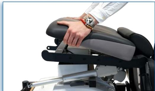
8. Para extraer correctamente el asiento: tire hacia arriba de la parte delantera de golpe y deslícela hacia delante; deje a un lado
