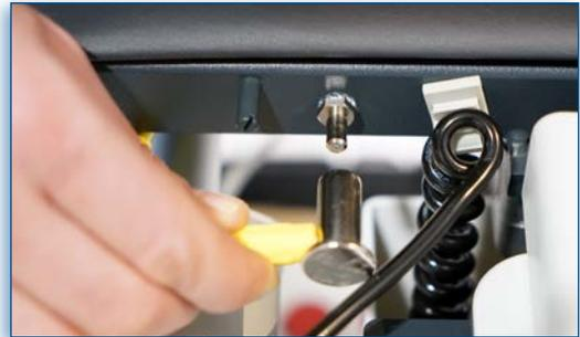
14. Conectar el cabezal del cable amarillo-verde de conexión equipotencial a la conexión PA. (señalización con símbolo ⚡)
