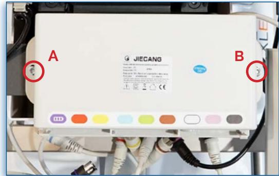
6. Sacar completamente los tornillos A y B
