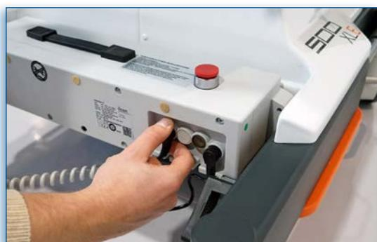
5. Desenchufar el cable de conexión del sistema de mando.
