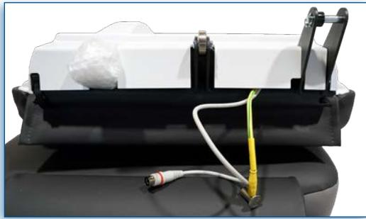
3. Saque el cable del motor de la calota de cabeza y del cable de la conexión equipotencial. A continuación, retire el material adhesivo restante.
