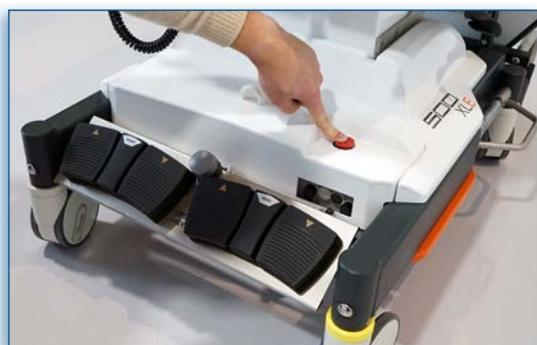
1. Extraer el panel de pedales y colocarlo en el suelo.
