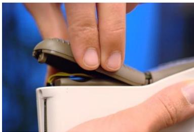
2. Levante la tapa del compartimento de la batería.
