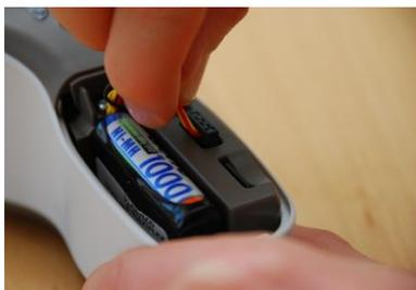
3. Retire la batería vieja. Encaje los cables de la batería con los dedos y retire el conector de su toma.
