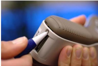
1. Abra el compartimento de la batería empujando e inclinando el botón a presión por el orificio que está junto al conector en la base del dispositivo. Para abrir el compartimento con más facilidad, se puede utilizar un bolígrafo, destornillador o utensilio similar.
