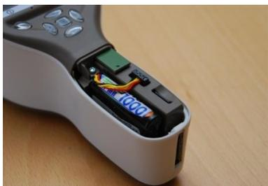
4. Coloque la batería nueva en la misma posición y conecte el conector a su toma.
